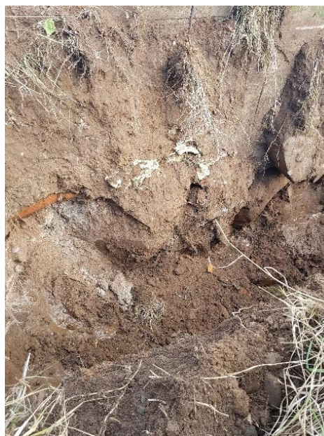
Figur 7. Till vänster avfall påträffat i deponi norr om betongplattan. Till höger provgröp med nederkanten av betongplattan längst upp i bild och stenblock som ligger under som utfyllnad. (Foto: Tyréns)
