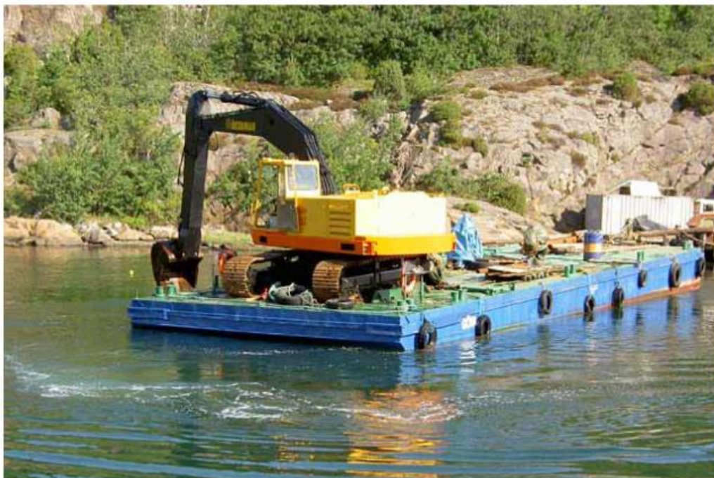
Figur 19. Exempel på enskopeverk på ponton (Miljösamverkan Sverige, 2006).
