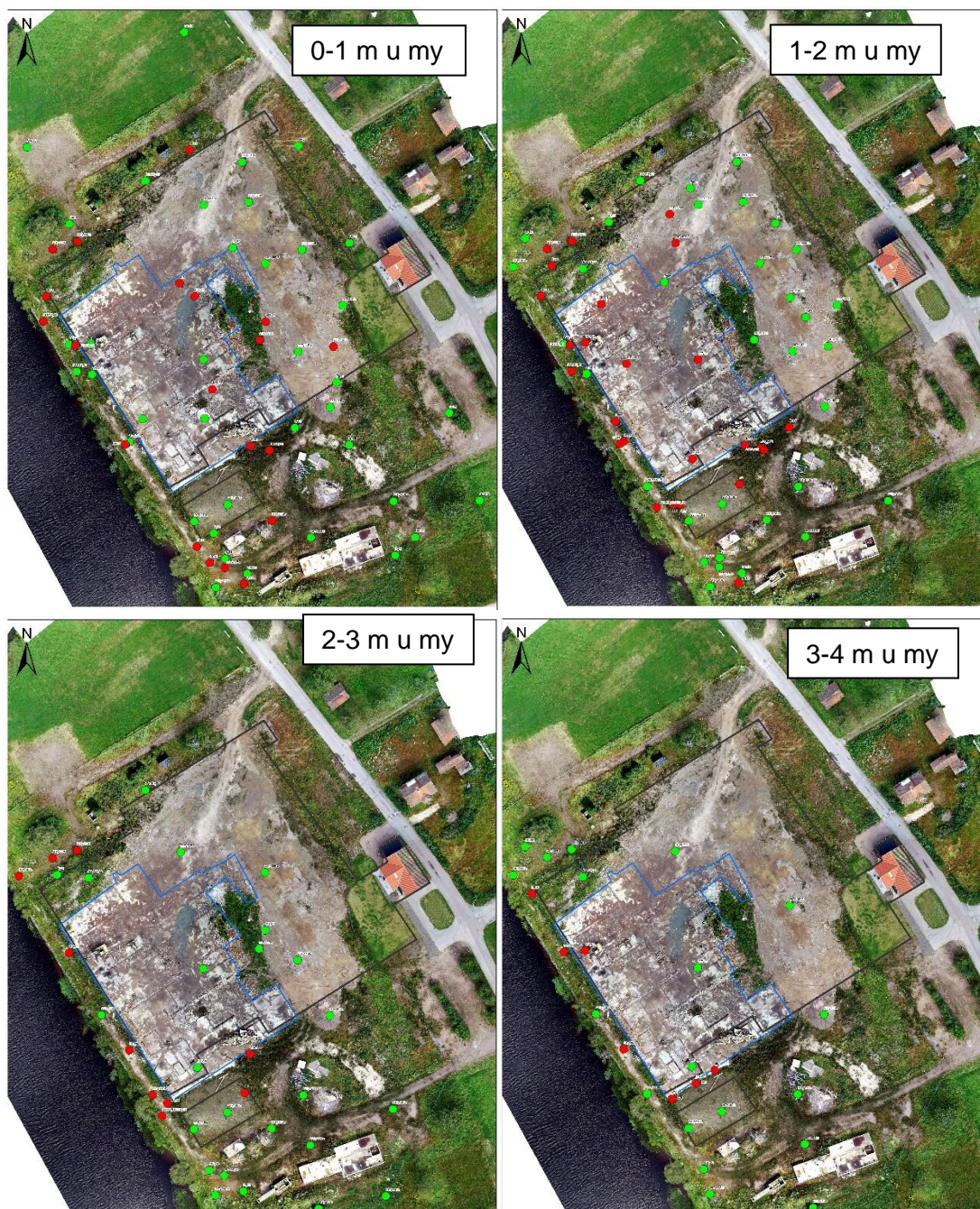
Figur 5. Föroreningsförekomst på olika djup i jorden (0-1 m u my uppe t.v., 1-2 m u my uppe t.h., 2-3 m u my nere t.v. och 3-4 m u my nere t.h.). Röda prickar innebär att föreslagna åtgärds mål överskrids för någon förorening, medan i gröna prickar har uppmätta halter av samtliga analyserade ämnen understigit åtgärds målet.
