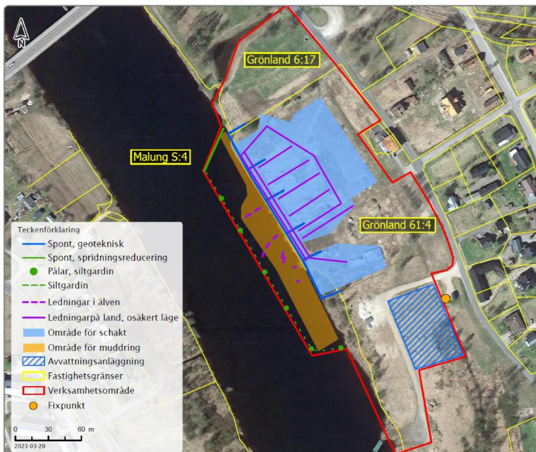
Figur 15. Översiktsbild över samtliga planerade åtgärder vid Malungs garveri. Det ljusblå området är det område som omfattas av jordschakt och det orange omfattas av muddring. Det streckade mörkblå är planerat läge för avvattningsanläggningen, men detta kan komma att ändras inom arbetsområdets gränser. De heldragna lila linjerna visar ungefärligt läge av ledningssystemet och de streckade är var ledningar i älven påträffats. Geotekniska spont är mörkblå linjer och i vattnet finns den heldragna gröna linjen (spridningsreducerande spont), till vilken siltgardinen är fäst (streckad grön linje).
